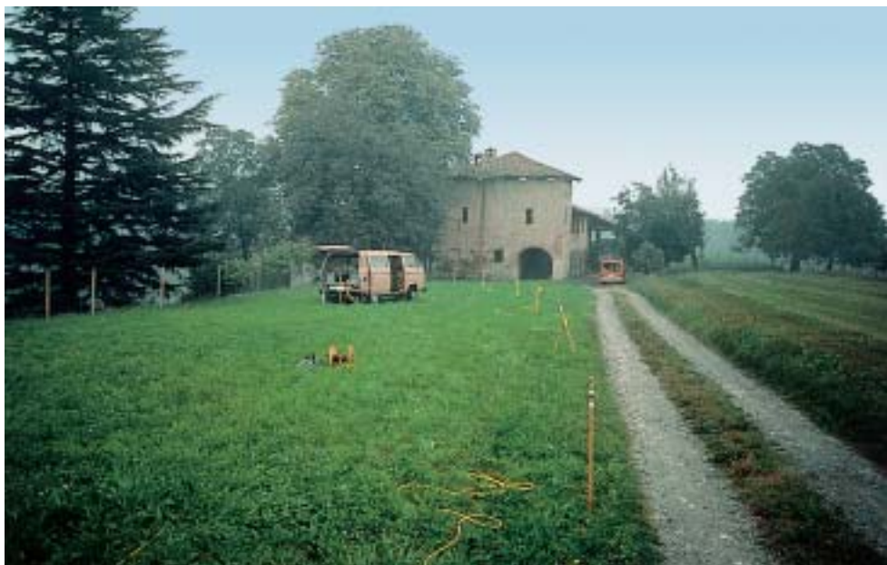
Rilevamenti di sismica a riflessione nei pressi della località Loi in Valle della Motta (Novazzano). Al centro la stazione di misurazione, in primo piano i cavi ed i geofoni per il rilevamento dei dati (foto M. Felber) 9 .
